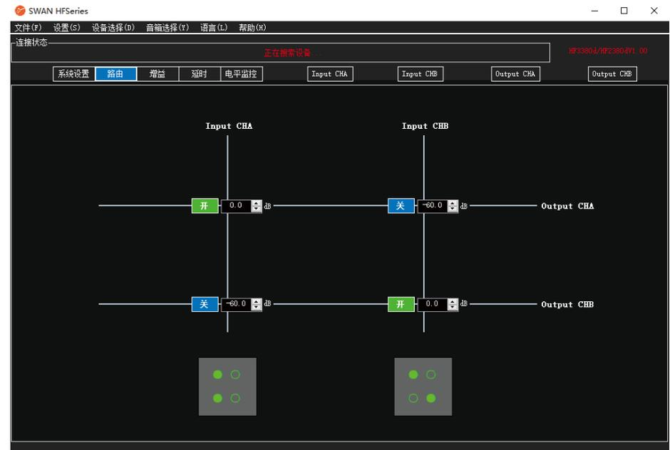
路由选择(有两种固定的路由方式,如果使用本机DSP,请选择一进二出的路由方式。如果使用外搭DSP,请选择二进二出的路由方式)
